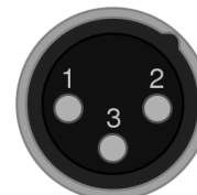
Разъем типа XLR 3 Cannon, штырь, вид со стороны штыревых контактов.
