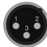
Рис.4 Нумерация контактов разъема типа XLR 3 Cannon, штырь. Вид со стороны штыревых контактов
