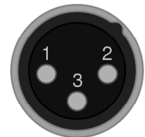
Рис.4 Нумерация контактов разъема типа XLR 3 Cannon, штырь. Вид со стороны штыревых контактов.
